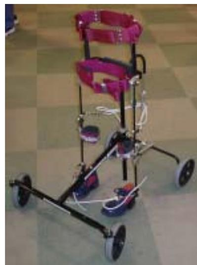
写真7 試作したHart Walker
