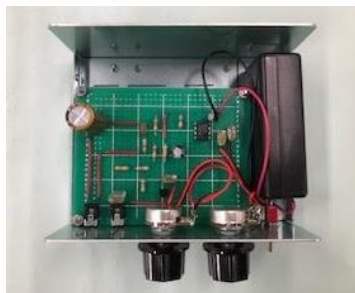
図 2 作成した ANC 回路
