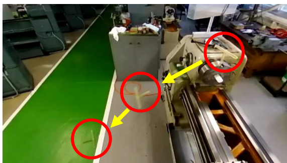
図1 チャックハンドル外し忘れによる事故の様子
