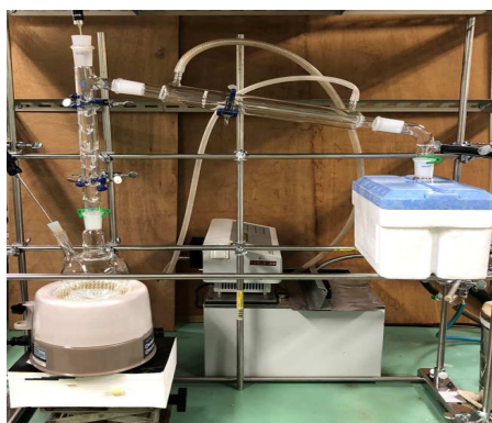
図 1. 減圧蒸留装置
