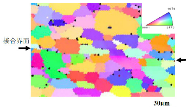
Fig. 2 #180 接合界面の IPF map 測定結果
