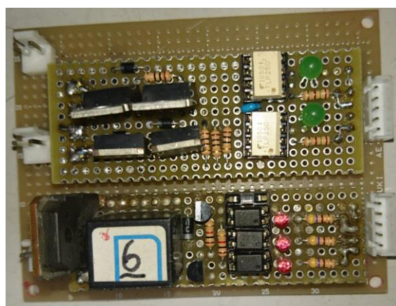
図 17 採用されなかった試作 H ブリッジドライバ(上)と 大会で使用されたモジュール化済リレー式モータドライバ(下)
