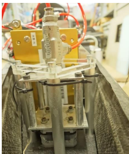
図 9 ニードルバルブ(左図中央上)とステッピングモータ(左図中央下)、 ステッピングモータドライバ基板(右図)
