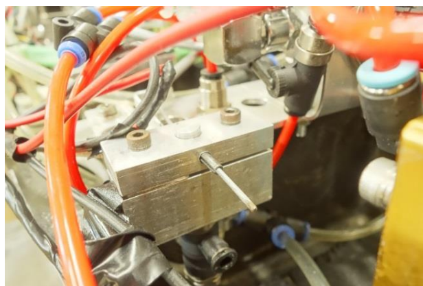
図 10 燃料遮断弁(ブロック中央のピンを紙面奥方向に引き抜くことで遮断)
