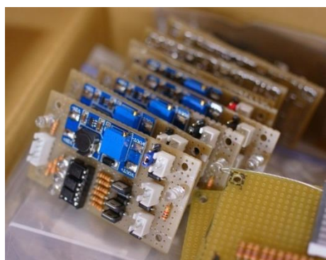
図 31 24V 電磁弁ドライバ
