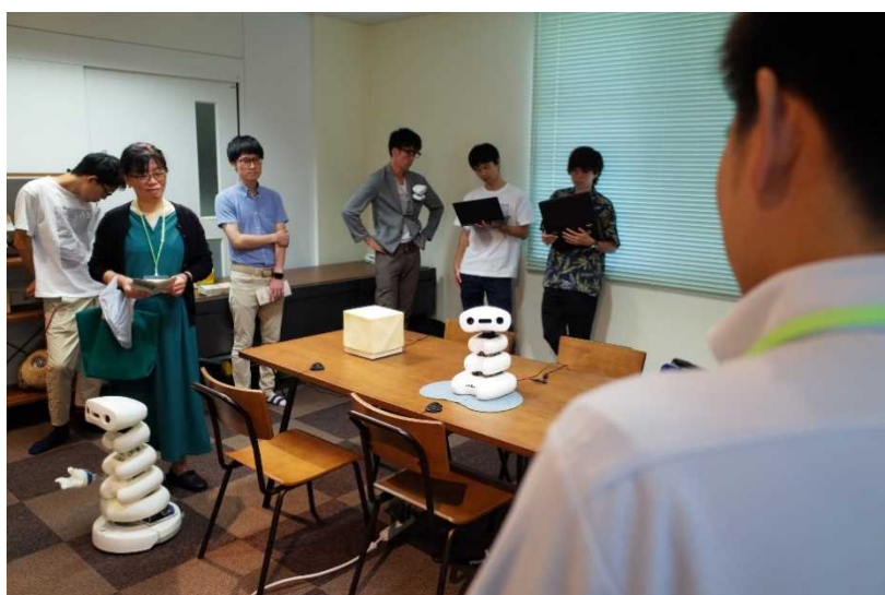
図5 ティッシュ配りロボット(図左下)と発話ロボット(図中央右)
