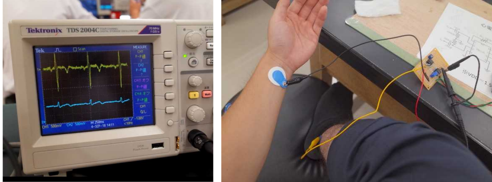
図 4 胸-腹間で計測した心電波形(左)と、腕-足間で計測の様子(右)
