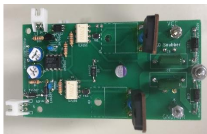
図 5 ハーフブリッジ基板(左)とインバータ(右) 図 6 フルトラ動作デモ
