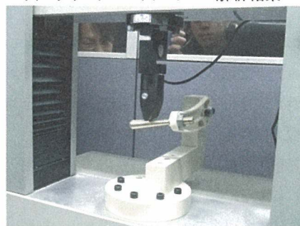
(d) ウインチハンドルの強度検証試験風景
