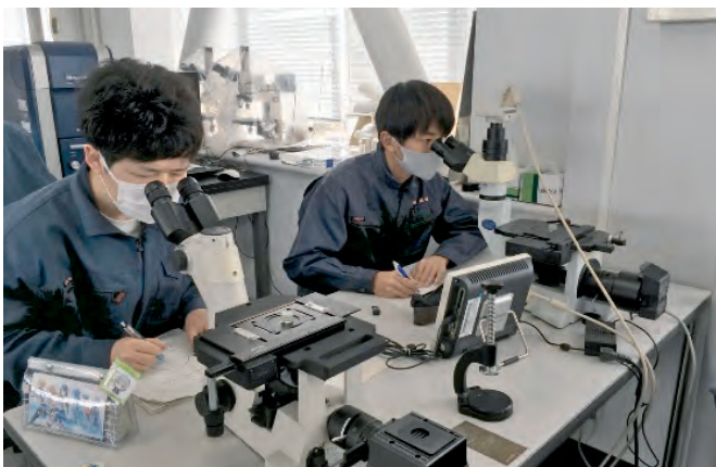
光学顕微鏡による金属組織の観察
