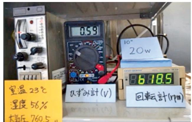
図2 トルク・回転用 計測装置
